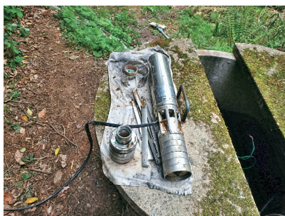
入石飲料水供給施設水源井戸ポンプ故障、タンク破損による断水件数24戸
