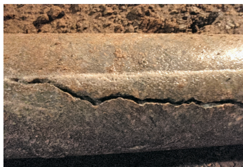
配水管ACPφ150漏水 作業断水による断水件数323戸
