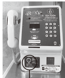
botão de emergência
